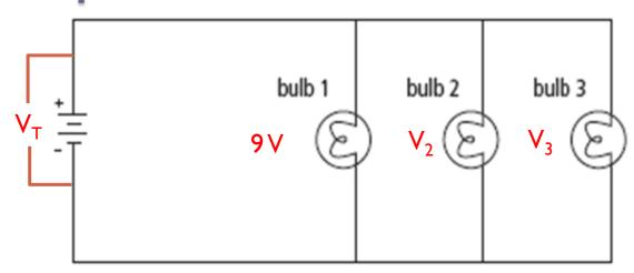
Calculate  $V_T$  ,  $V_2$  ,  $V_3$
